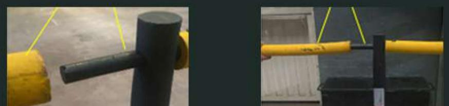
Conexión macho hembra de cada una de las secciones
